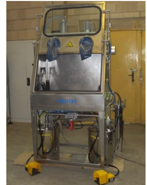
Modell „P“ für brennbare Reiniger (Ausführung mit 2 Fässern, 2 Pumpen, Feinfilter, Beleuchtung)
