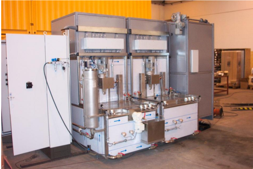
Filtersysteme und Entöleinrichtung erhöhen deutlich die Standzeit der Bäder. Senkrecht stehende Heizstäbe ermöglichen Wartung ohne das Bad abzulassen
