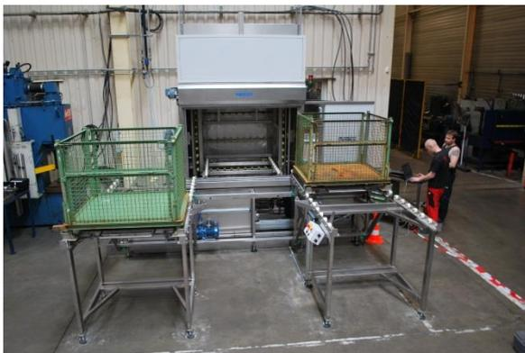
Gitterbox mit 1200x1000x1000mm und 1.500 kg Nutzlast
