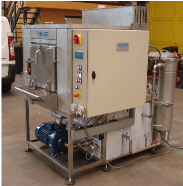
ROTOR 60 mit Beutelfilter, Schwadenkondensator, Heiß-/Umlufttrocknung uvm.
