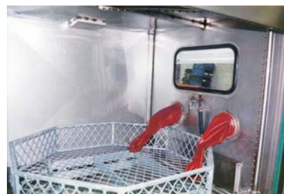
Spritzkabine mit Korb, Düsenrahmen und optionaler Handwascheinrichtung.
