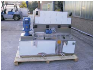
Version mit außen liegendem Tank in Kaskade und senkrechter Pumpe z.B. zum Entlacken oder für sehr stark verschmutzte Teile
